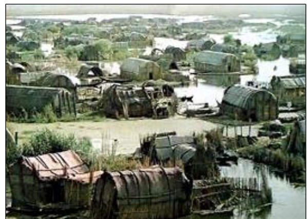
الشكل (7) الصرائف السكنية في الأهوار وفيها تستخدم السقوف الجملونية المثلثية
